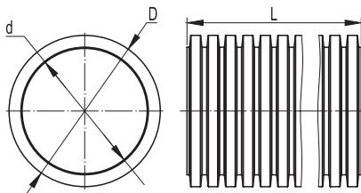
Усиленная двустенная труба (16 серия), является модификацией двустенной гибкой электротехнической трубы 12 серии с аналогичной сферой применения: в строительстве кабеленесущей канализации для линий электропередачи напряжением до 10 000 В, и информационных линий, линий связи (в т.ч. ВОЛС) прокладываемых в грунте, и под заливку в бетон.
