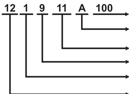
для трубы 12 и 14 серии количество метров в бухте\*, если это отличается от основной упаковки; для трубы 16 серии – показатель кольцевой жесткости: 8К – 8 кПа; 6К – 6 кПа\*\*;
